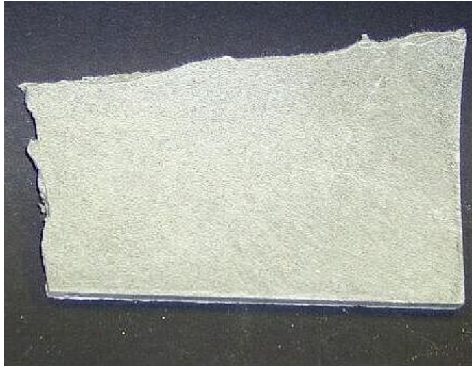
Figuur 6: breukvlak met fijnere vezels (asbestvrij)
