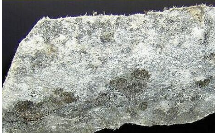
Figuur 3: breukvlak met asbestvezels
